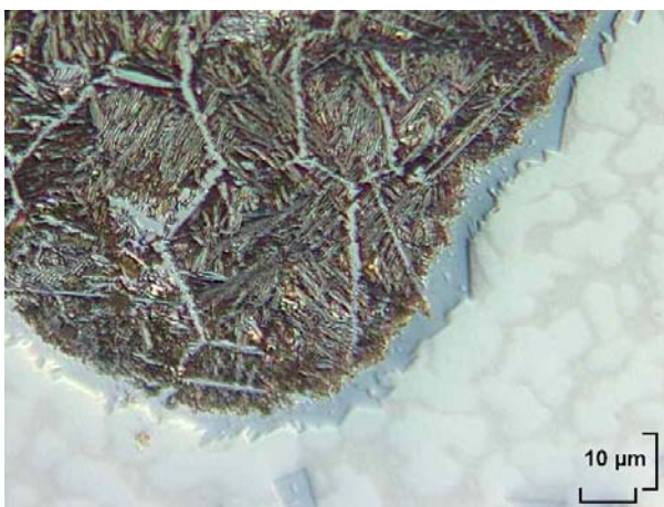
Abb. 6: Mikrogefüge einer WSC-verstärkten Fülldraht-Auftragschweißung auf NiBSi-Basis
