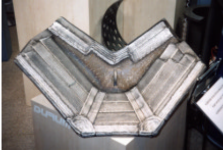
Abb. 8: Schalenschneiden für den Braunkohle-Tagebau
