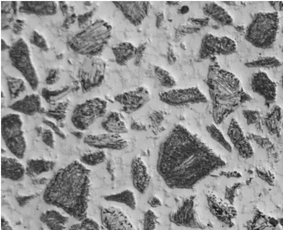
Bild 5. Mikrogefüge PTA-Auftragschweißung: NiBSi + 60%WSC (V=100:1)
