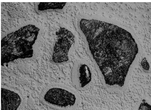
Bild 6. Mikrogefüge PTA-Auftragschweißung: NiBSiVC+60%WSC (V=200:1)
