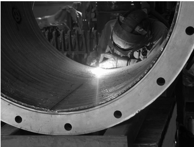
Bild 8. PTA-Panzern von Verbindungsschweißungen Fig. 8. PTA-hardfacing of joint welds
