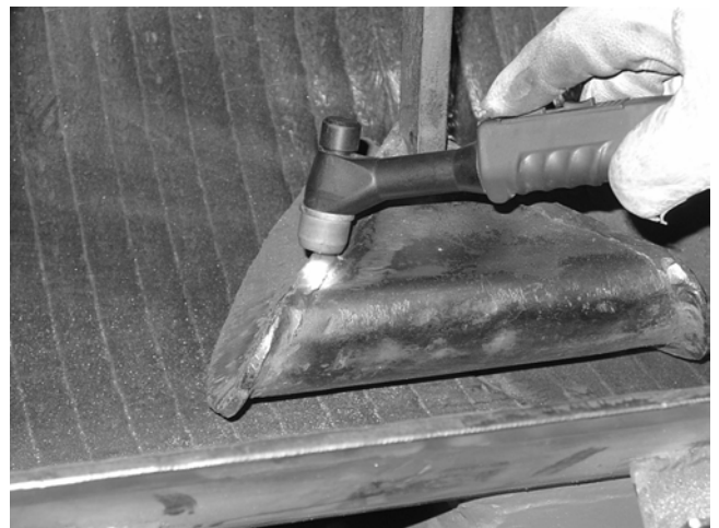
Bild 7. PTA-Handbrenner: Panzern von Mixern Fig. 7. PTA-manual torch: hardfacing of mixers
